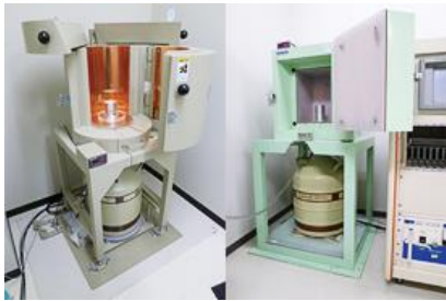
検査で使用するゲルマニウム半導体検出器は、現在3台が稼働しています。
