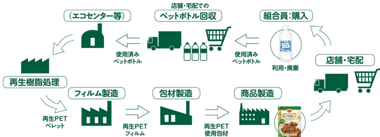
回収 PET ボトル再生利用の流れ
