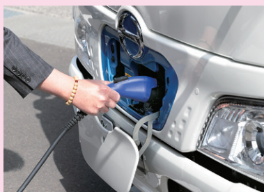
EVトラック フロント部分の充電口
