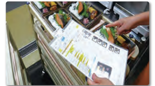
▲ラベル発行担当者が実際の商品とマニュアルの写真が合致しているか確認します。
