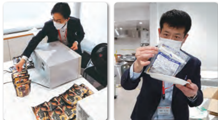
▲(左右)電子レンジで加熱後のピンホールの有無を確認しています。
