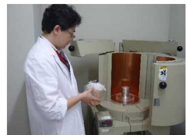
ゲルマニウム半導体検出器の重さは1トン以上。わずかな面積に大きな荷重がかかるため、床が抜けないように補強されています。
