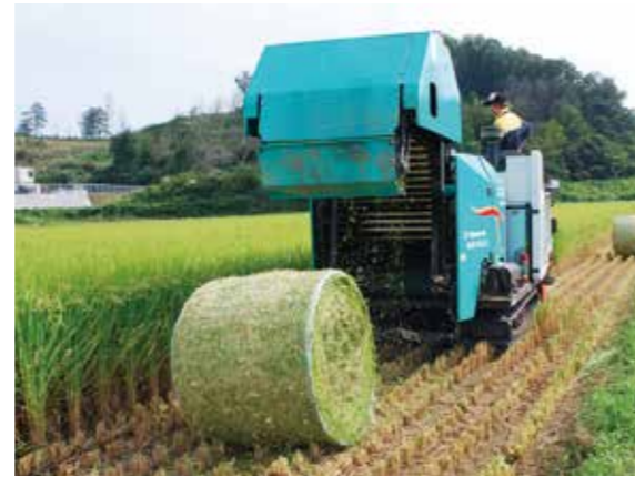
飼料用米を作る様子▶ 刈り取った稲を円筒状にし乳酸発酵させたもので、牛などの餌になる。
