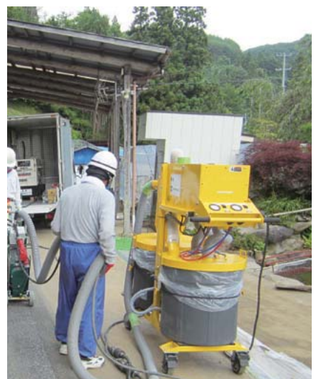
削った粉が飛散ないように、集塵機で吸い取りながら行なう。こちらは、ならコープの寄贈。
